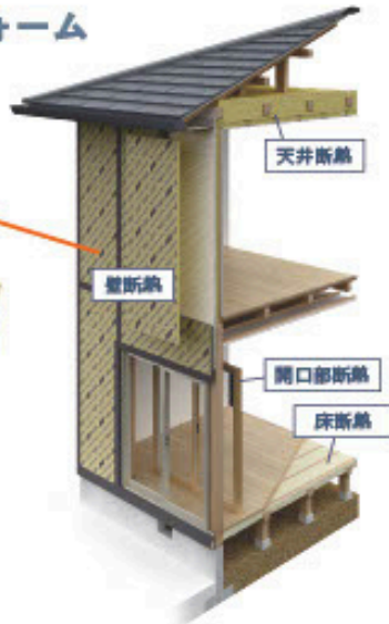
断熱リフォームパネル (硬質ウレタンフォーム断熱材)
