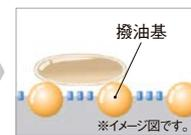
撥油基(油をはじく成分)があるため、床表面に皮脂汚れが固着しにくい。
