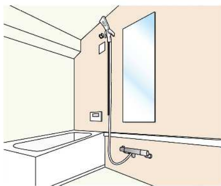
シャワーのホースは床につかないよう、高い位置に掛けることで、ホースのカビも防げます
