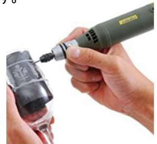
ダイヤモンドビットを使用してガラス彫刻。
