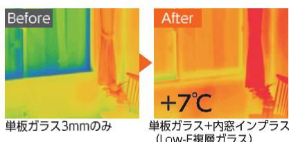
内窓を取付けると、外気の侵入を防ぎエアコン効率もアップ。結露も軽減します。
