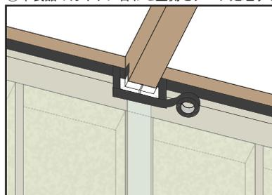
④本製品の切り込み部分、梁周りをテープ処理し完了
