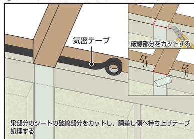
②柱のサイズに合わせて本製品をカットし、取付ける
