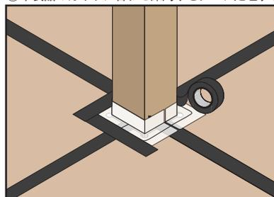
④本製品の切り込み部分、柱周りをテープ処理し完了
