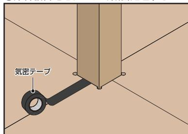
②切り込み部分より柱へ本製品を取付ける
