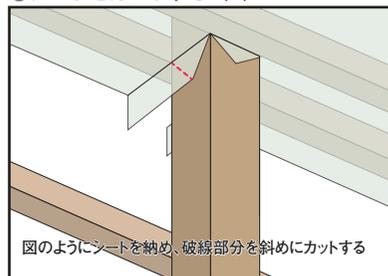
③本製品を切り込み部から柱へ取付ける
