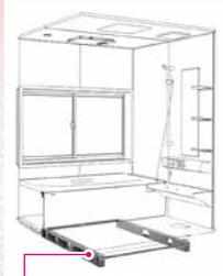
安定性抜群の床フレーム架台。震度6強相当の振動にも耐える頑丈な構造。
